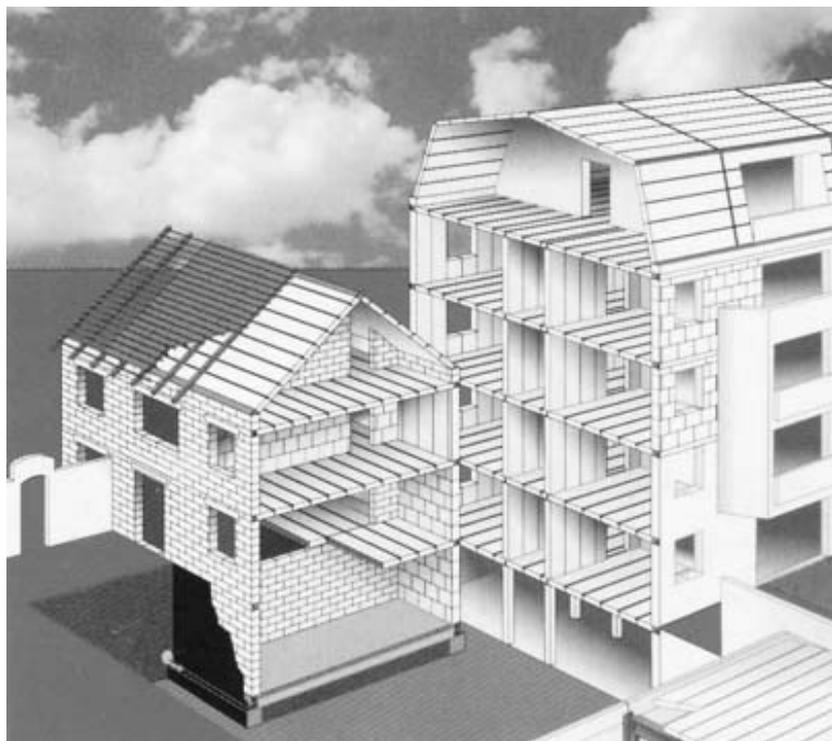
Рисунок 4.4.1 - Применение ячеистобетонных изделий в жилых зданиях (стеновые блоки и панели, плиты покрытий и перекрытий)
