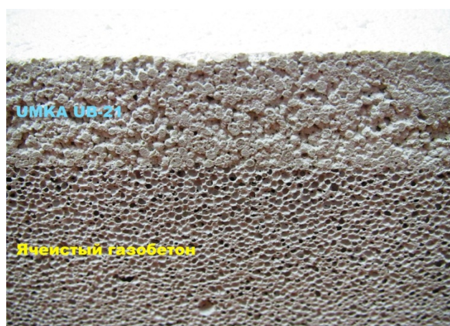
Рис. 1. Макросъемка среза штукатурного слоя УМКА UB-21, нанесенного на газобетон.
